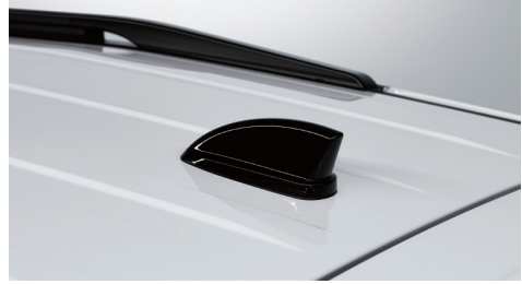
GLONASS Kopekbalığı Yüzgeci Anten, DAB ve GSM özellikli
